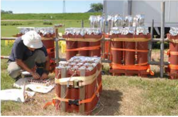
花火打上現場(打上筒と点火モジュール)
