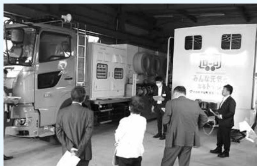
排水ポンプ車（左）とトイレトレーラー（右）
