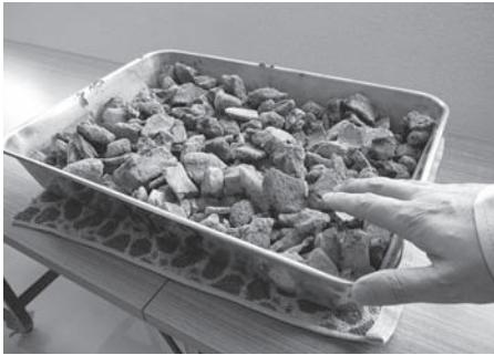
焼却灰の試験試料(平成24年3月28日に大仙美郷クリーンセンターで撮影)
