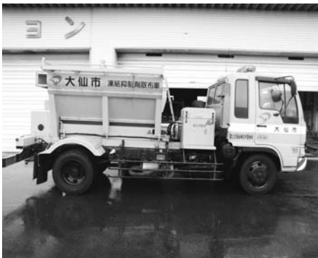
大曲地域に配備されるものと同型の凍結抑制剤散布車
