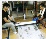
版木ロールに原紙を巻きつけ、刷毛で叩いて模様凹凸を写し出す
