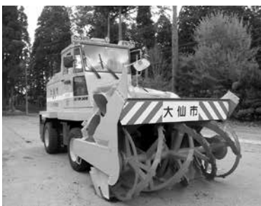
西仙北地域に配備されるものと同型のロータリ除雪車
