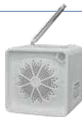
防災ラジオは自動的に電源が入り、起動信号音の後に試験放送が流れます。
