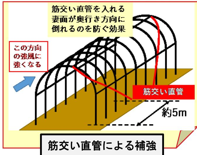
筋交い直管による補強
