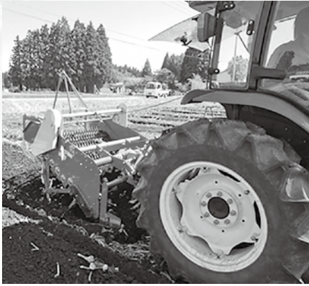
トラクター後部の「にんにく収穫機」
