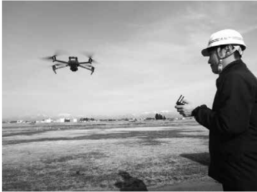
赤外線カメラにより、クマの体温を感知するサーマルドローン
