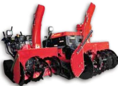
小型除雪機械（左）と中型除雪機械
