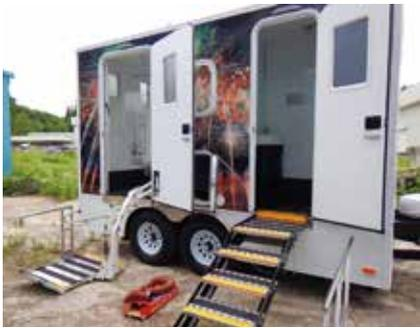
市が導入したトイレトレーラー（写真上が移動時、左が稼働時）。電動リフト付きで、車いすでの利用もできます。また、ソーラー発電により、停電時でも照明や換気扇などを使用できます。
