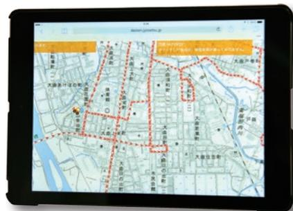
除雪車両に搭載したGPS端末を活用した「除雪情報提供システム」を導入し、市のホームページで公開。除雪車両の稼働状況(現在位置や稼働軌跡)や毎日の降雪状況をパソコンやスマートフォンでご覧いただけます。
