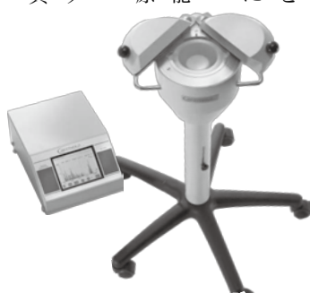
測定に使用する簡易型ガンマ線スペクトロメーター
