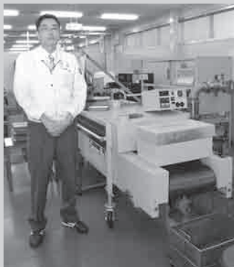
ばねの生産過程で重要な役割を担う「熱処理炉」。「効率はやや落ちましたが、処理が必要なばねをまとめるなど工夫して、稼働時間を短縮しました」と渡邊さん
