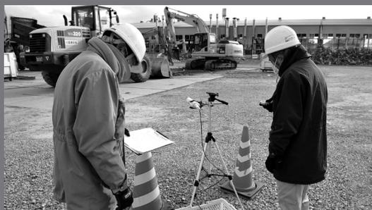
1時間おき1日7回、作業エリアの線量を測定
