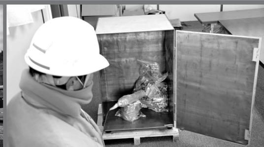
トラック積み込み前にがれきのサンプルを空間放射線の影響を受けにくい鉛の箱の中で測定
