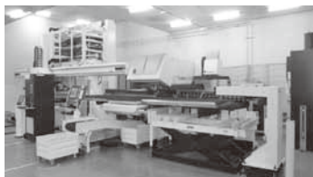
①抜き工程 レーザー複合機(TruMatic7000)
