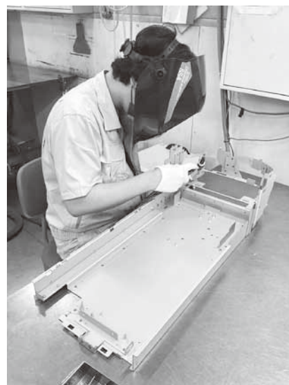
Tig溶接機で溶接の作業を行います。
