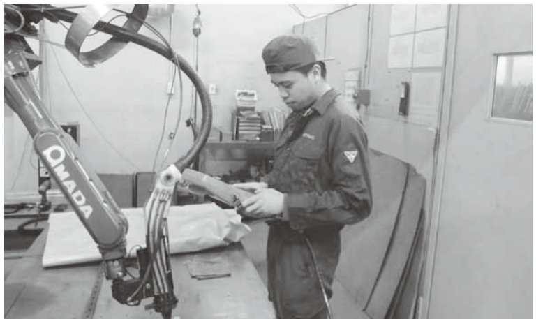
【溶接】歪みの出ないヤグ溶接機で溶接します。
