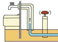
水抜き栓のハンドルを完全に開ける。
