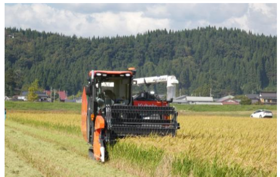
乾田直播ほ場において、R T K基地局を活用した自動操舵コンバインによる稲刈りのようす
